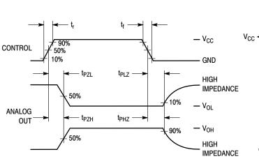
Figure 12. Turn-ON / Turn-OFF Times
